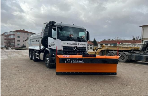
Mercedes Benz Arocs 3345K/6x4/3600 mm, Euro 6 Motorlu, Havuz Tipi, 7 m³ Kapasite Solüsyonsuz Tuz Sericili Damperli Kamyon
